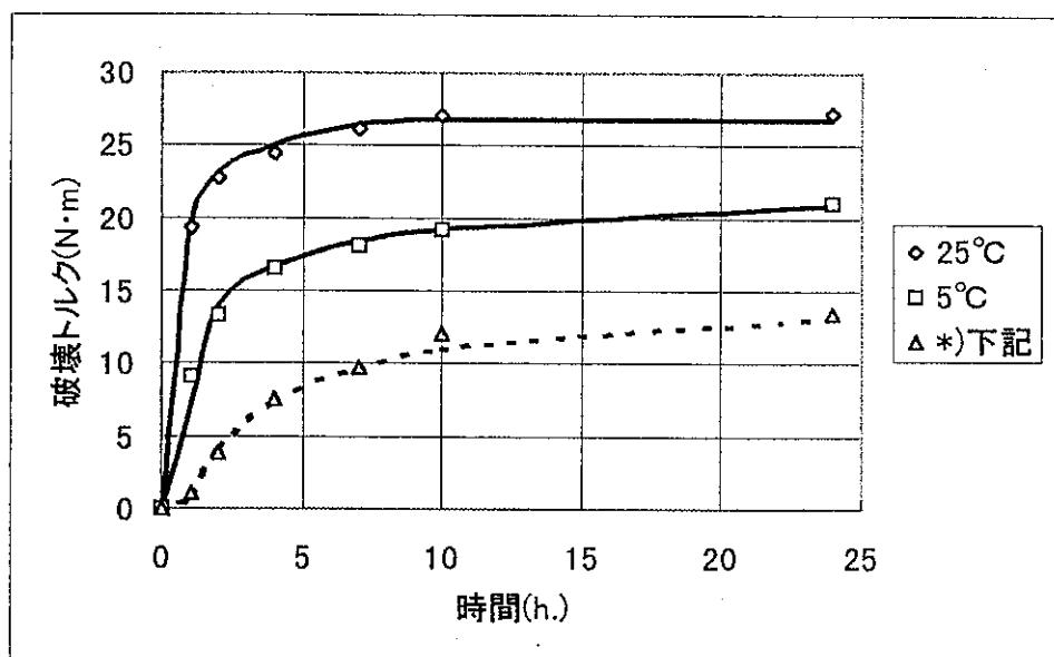
試験条件 試験片：軟鋼ボルト/ナット M10 ピッチ1.5 並目
