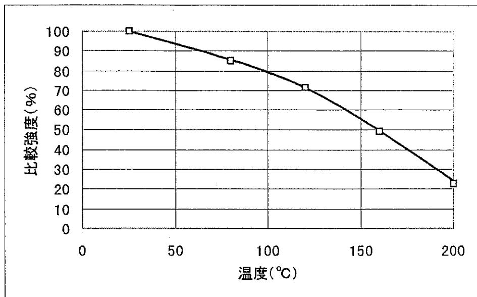
試験条件 前記軟鋼ボルト／ナットに ThreeBond 1322N を塗布し、締め付け 0 N·m にて 25°C で 24 時間養生した後、各温度下にて 1 時間放置し、その温度下にて破壊トルクを測定
