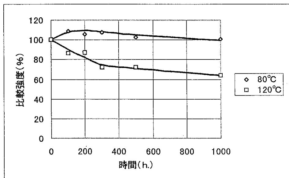
試験条件 前記軟鋼ボルト／ナットに ThreeBond 1322N を塗布し、締め付け 0 N·m にて 25°C で 24 時間養生後、各温度下にて放置し、各時間後に取りだし 25°C で 1 時間放置後破壊トルクを測定
