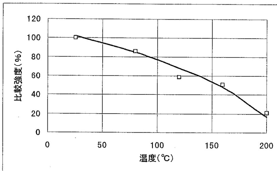
試験条件 前記軟鋼ボルト/ナットに ThreeBond 1305N を塗布し、締め付け 0 N・m にて 25°C で 24 時間養生した後、各温度下にて 1 時間放置し、その温度下にて破壊トルクを測定
