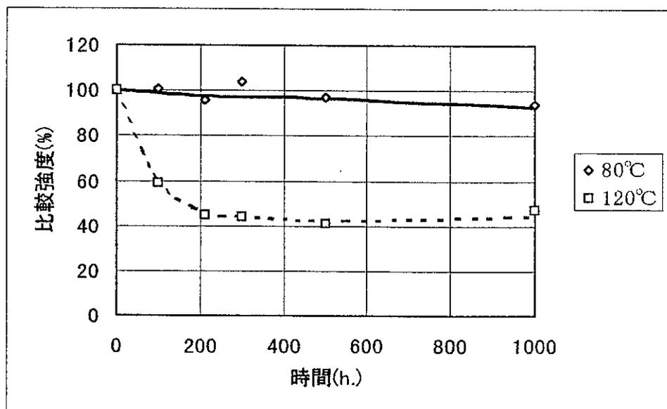
試験条件 前記軟鋼ボルト/ナットに ThreeBond 1305N を塗布し、締め付け 0 N・m にて 25°C で 24 時間養生後、各温度下にて放置し、各時間後に取りだし 25°C で 1 時間放置後破壊トルクを測定
